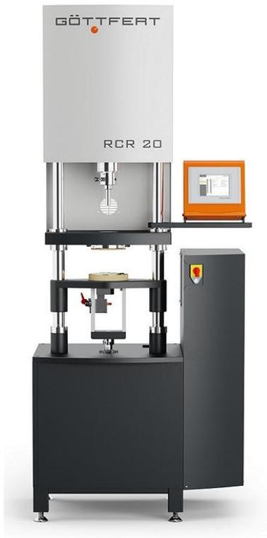
Pour les matériaux élastomères, c'est le rhéomètre capillaire en caoutchouc qui est susceptible d'éveiller votre intérêt. Il est spécialement conçu pour étudier, sous des conditions de traitement, le comportement en écoulement de composés de. Que ce soit pour le test des polymères ou des élastomères – Göttfert propose le logiciel compétent pour la détermination et le traitement des données, non seulement pour le protocole ou la base de données, mais également pour les calculs de simulation.
