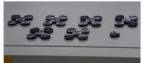
Durchführungen für Kabel und Lastleitungen.
