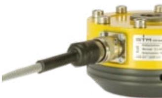
Kraft-Beschleunigungsaufnehmer mit Fußplatte
